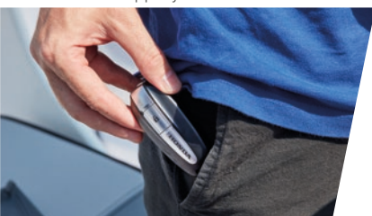
Wegfahrsperre. Die Zündung kann nur aktiviert oder deaktiviert werden, wenn sich der Schlüssel im Bereich von 80 cm zum Empfänger befindet.
